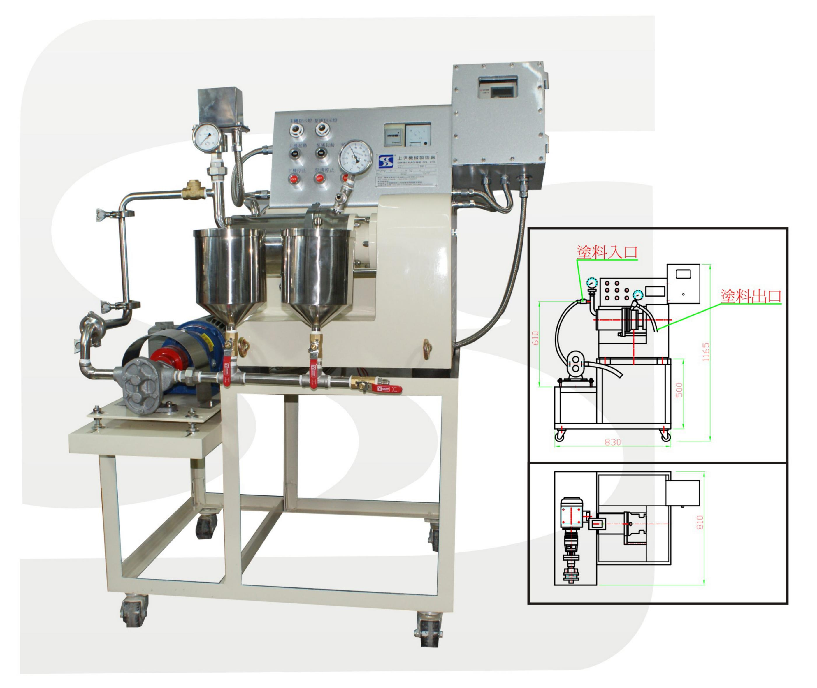
➢ SGM-1.4L卧式砂磨机是针对实验室窄小空间,而设计成灵巧又实用之实验机械。
